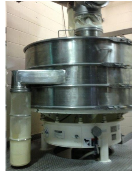
Under silo 1600mm \varnothing , nedanför konisk 200 \rightarrow 250mm Mjölkpulver-sikt
